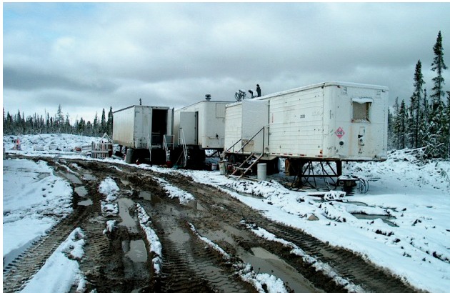
figure 13. Poursuivre les activités trop tard au printemps peut causer un profond orniérage et l'érosion du sol.
