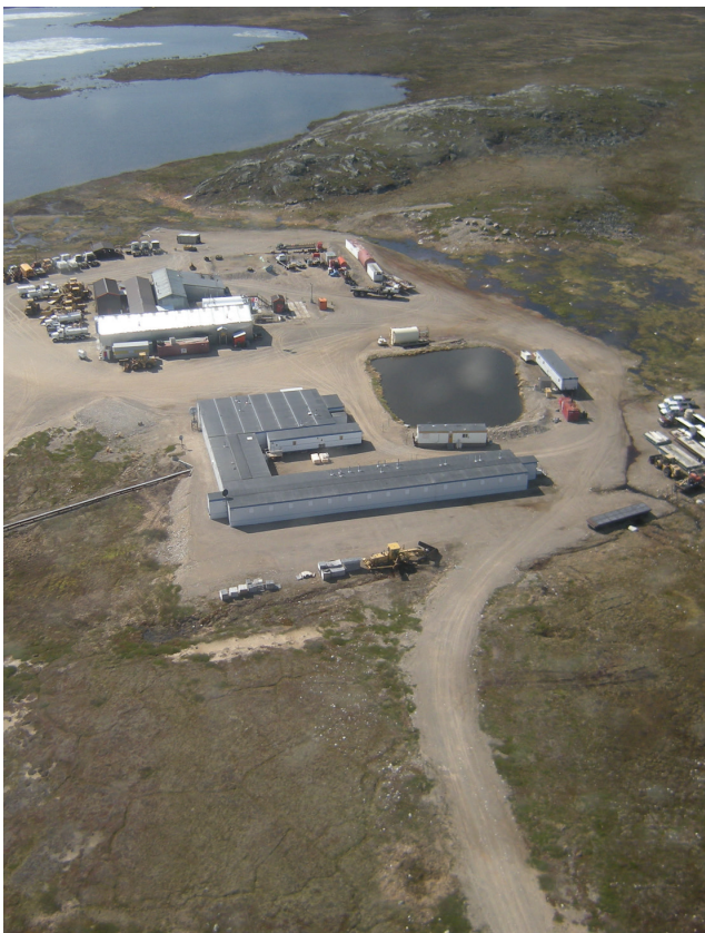
figure 23. Grand campement fixe avec bassin d'épuration des eaux résiduaire.
