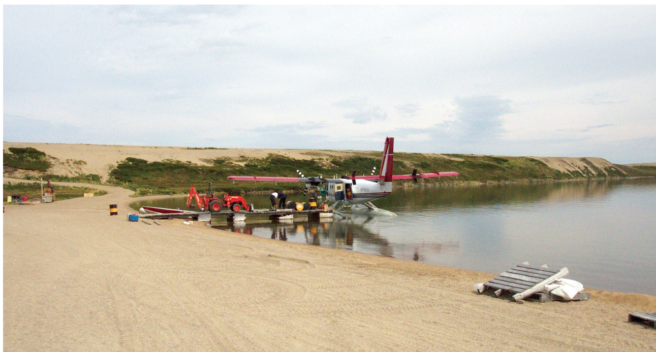
figure 12. Un quai doit être situé dans un lieu abrité, au rivage doucement incliné et suffisamment profond pour les hydravions et les bateaux.
