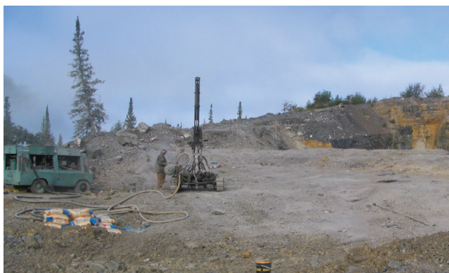
figure 21. L'extraction de la roche fait appel au forage et à l'abattage à l'explosif.
