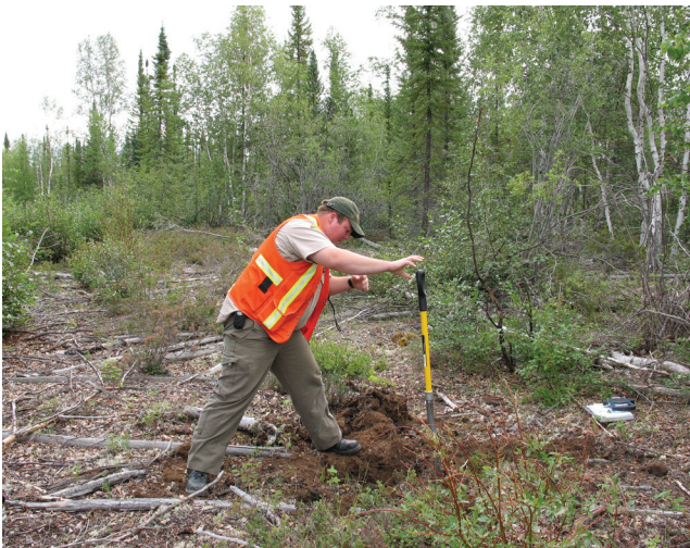
figure 3. Foreuse portable employée pour l'exploration avancée des gisements de matériaux granulaires.
