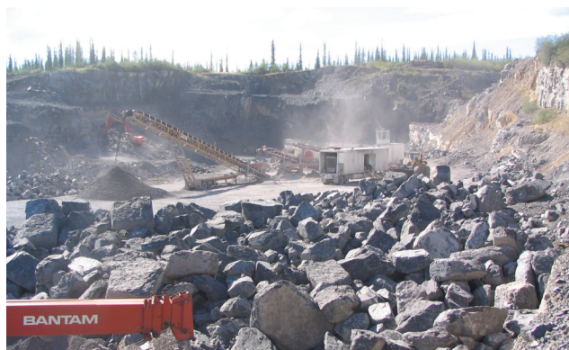
figure 22. On peut limiter l'empoussièrement créé par le concassage en aspergeant d'eau le matériau ou en équipant les convoyeurs de pare-poussières.
