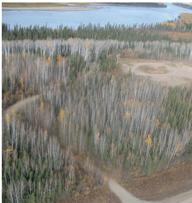
figure 8. Carrière bien conçue, avec accès coudé et tampons de végétation.
