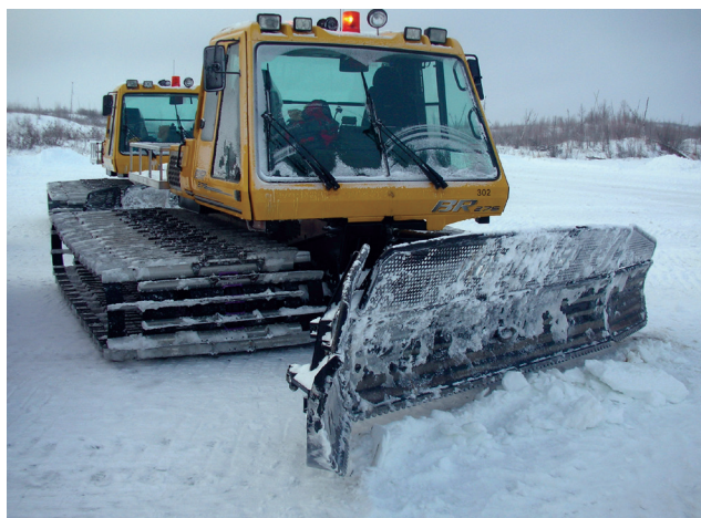
figure 35. Un véhicule à basse pression au sol, comme un tank des neiges, peut être utilisé pour la première passe de compactage de la neige sur une route d'hiver.
