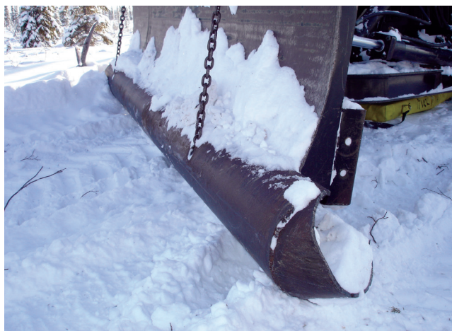
figure 34. Une lame de lissage soulève la lame du boteur de la surface du sol.
