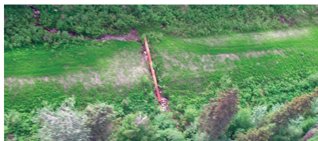
figure 50. Ce site a été remis en état selon des lignes et des niveaux appropriés et il a été convenablement revégétalisé, mais le pontceau doit être enlevé.
