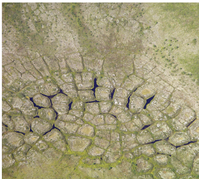
figure 10. Dans le cas d'un terrain de pergélisol, on ne doit pas construire de routes sur un sol géométrique.
