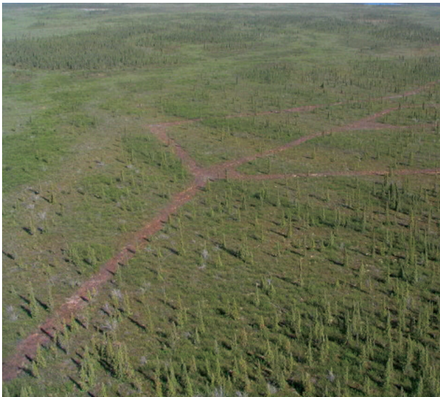
figure 8. Déterminer s'il est possible d'utiliser des routes existantes. Une planification adéquate aurait peut-être permis d'éviter le réseau de routes qu'on peut voir sur la photographie.
