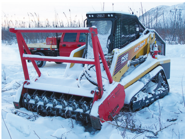
figure 30. Utilisation d'une déchiqueteuse pour l'enlèvement des broussailles.
