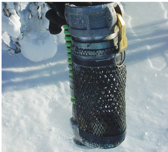
figure 13. Les grilles d'entrée utilisées aux fins du prélèvement de l'eau doivent être conformes aux Directives concernant les grillages à poissons installés à l'entrée des prises d'eau douce de Pêches et Océans Canada.
