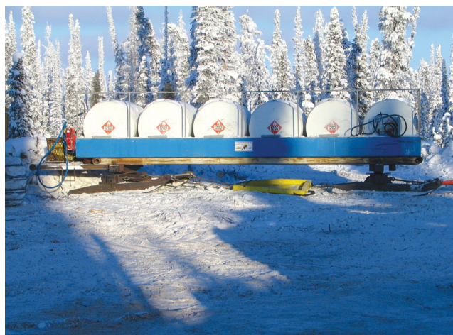
figure 39. Traîneau citerne utilisé pour le transport de combustible le long de lignes sismiques.
