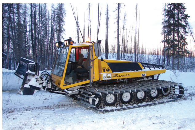
figure 20. Il est recommandé d'utiliser de l'équipement à faible pression au sol sur les terres de la toundra.
