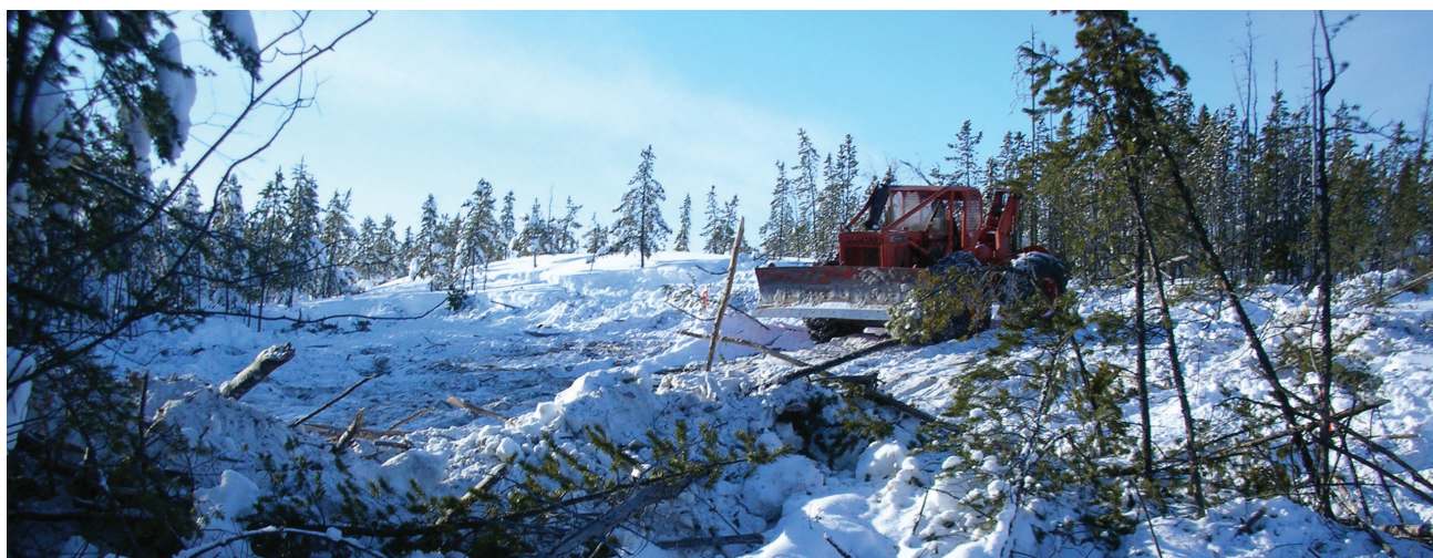
figure 24. L'utilisation d'une débusqueuse dotée d'une lame de lissage est une méthode acceptable de défrichage sur les terrains relativement plats.
