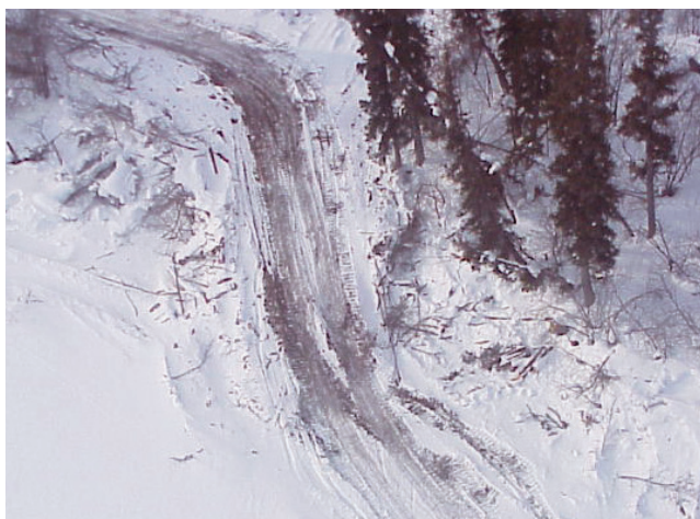
figure 9. Il faut éviter de créer des lignes sismiques sur les berges abruptes en bordure des plans d'eau car le patinage des chenilles peut entraîner une érosion. Les lignes doivent croiser les plans d'eau à angle droit afin de réduire la perturbation de la zone riveraine.
