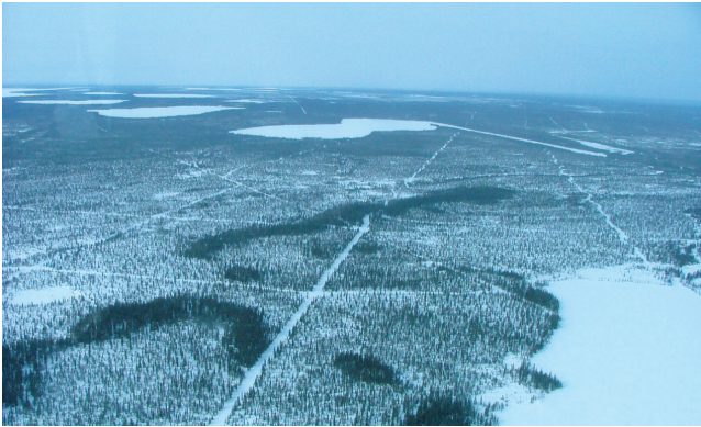
figure 8. Utiliser les perturbations existantes et les ouvertures naturelles, le cas échéant, afin de réduire au minimum l'empreinte du projet. Certaines de ces bandes défrichées existantes pourraient être utilisées pour accéder au site d'un nouveau programme de prospection sismique.
