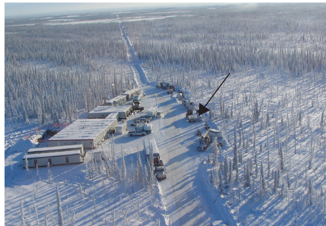
figure 37. Une quantité minimale de combustible est stockée sur le lieu de ce campement mobile dans un réservoir à double paroi, à l'endroit indiqué au moyen de la flèche.
