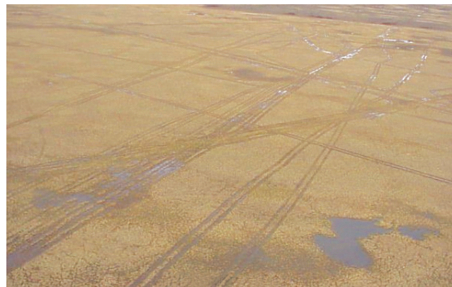
figure 35. Utilisation inappropriée d'une ligne sismique, mise en évidence par les nombreuses pistes parallèles qui ont considérablement accru l'empreinte du projet.
