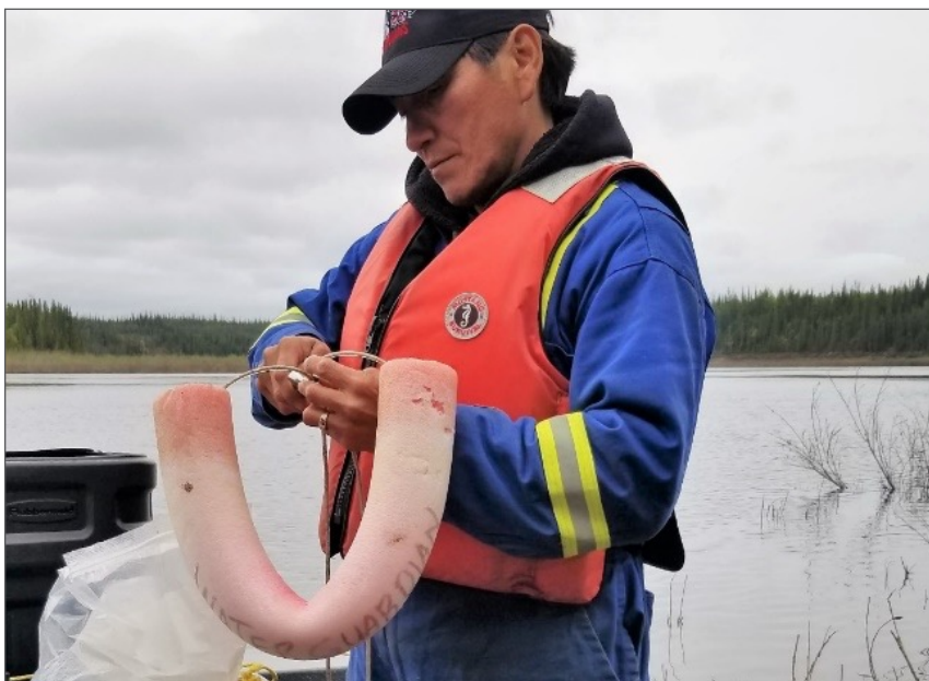
Buddy Gully, gardien de K'ahsho Got'ine, prépare un dispositif à membrane semi-perméable en polyéthylène pour prélever des échantillons d'eau. (Photo : K. Gurney)
